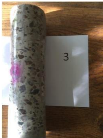
Prøven består af beton med 1 – 2 mm. cementslam i top og i bunden.
