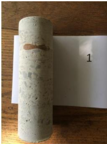
Prøven består af beton med 1 – 2 mm. cementslam i top og i bunden der her er malet
