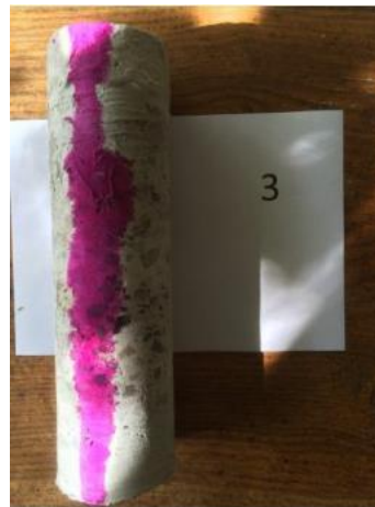
Der fandtes ikke Klorid i prøven og det var kun de yderste 1 mm der var karbonatiseret både i top og i bund
