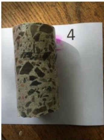
Prøven består af beton med puds som granitpuds eller lignende
