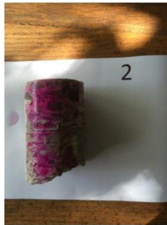
Der fandtes ikke Klorid i prøven og det var kun de yderste 1 mm. der var karbonatiseret.
