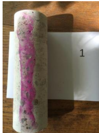
Der fandtes ikke Klorid i prøven og det var kun de yderste 1 – 2 mm der var karbonatiseret både i top og i bund
